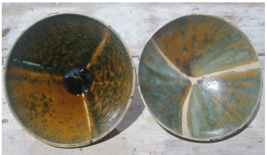
Bo Filarski, Glazuurtest schalen, 2011; Gres de St. Amand en Puisaye, kristalstook 1265° C + pendelen; in de drie segmenten is elke keer 1 gram meer zinkoxide toegevoegd. Elk segment apart is onderverdeeld in (tegen de klok in) 2-3-4-5-6 lagen glazuur; h. 15 cm, Ø 30 cm
